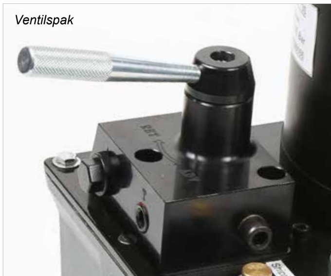
Oljeflödet styrs med en manuell riktningventil (2/2) för tryck och retur.
